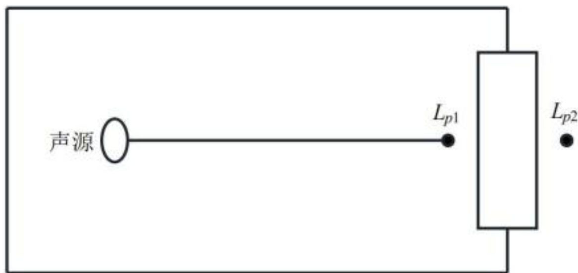
图 6.2.5-1 室内声源等效为室外声源图例
