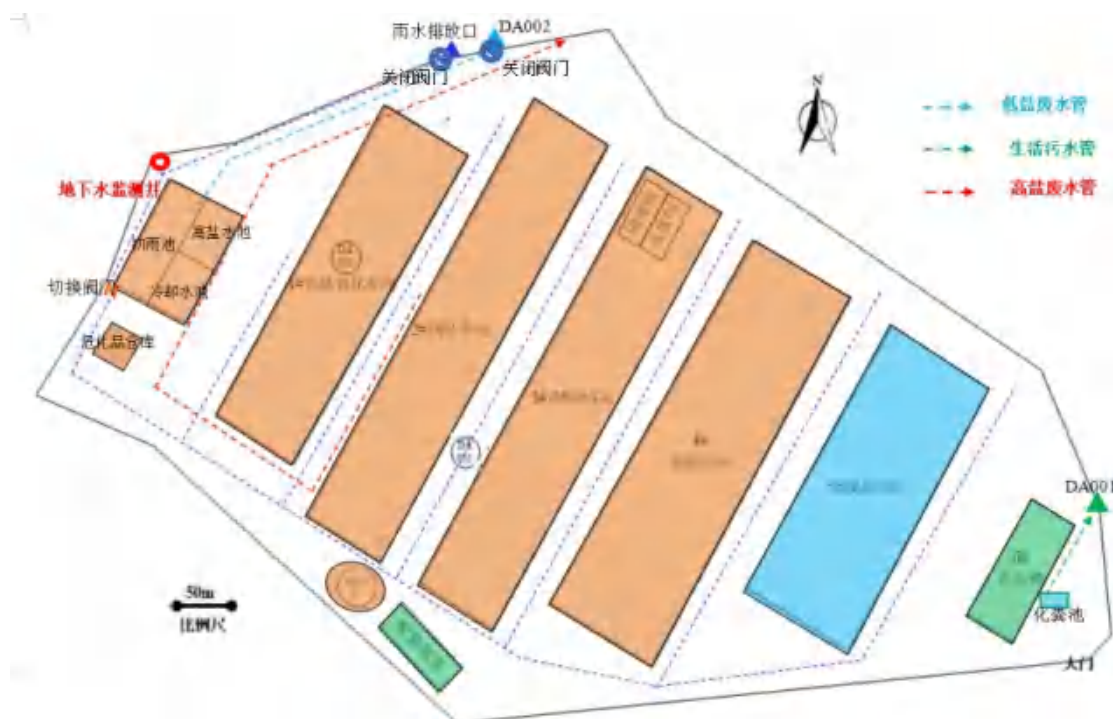
图 7.6-1 防止事故水进入外环境的控制、封堵系统图
