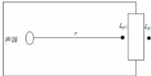
图 4-1 室内声源等效为室外声源图例
