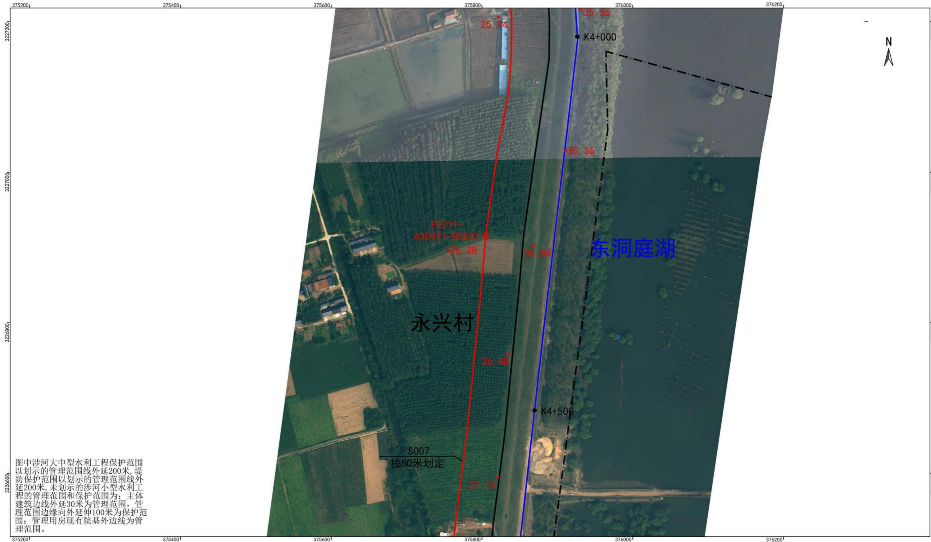
图中涉河水利工程保护范围堤外工程的管理范围和保护范围为：主体建筑边线外延30米为管理范围，管理范围边缘向外延伸100米为保护范围：管理用房现有院基外边线为管理范围。
