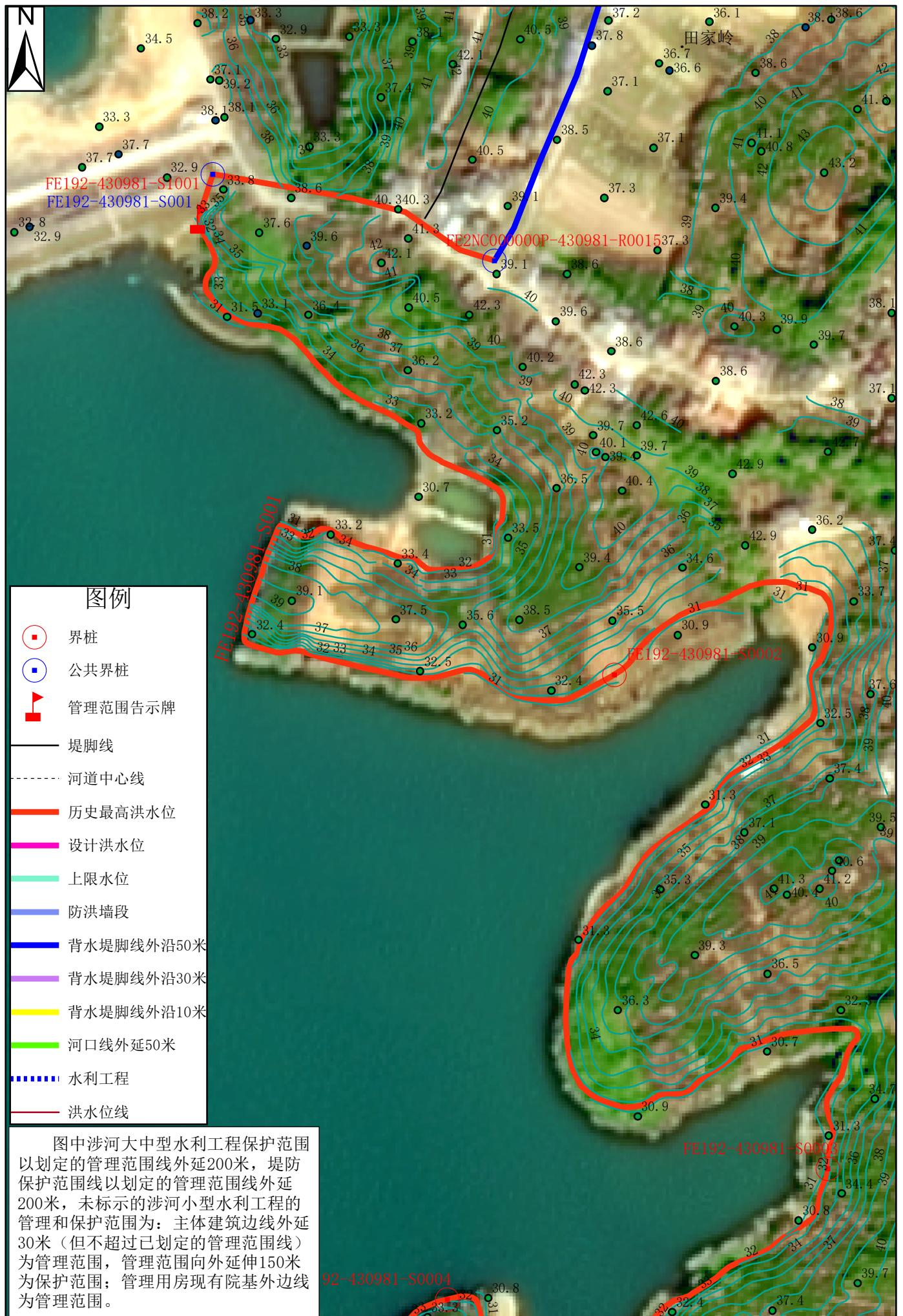
图中涉河大中型水利工程保护范围以划定的管理范围线外延200米，堤防保护范围线以划定的管理范围线外延200米，未标示的涉河小型水利工程的管理和保护范围为：主体建筑边线外延30米（但不超过已划定的管理范围线）为管理范围，管理范围向外延伸150米为保护范围；管理用房现有院基外边线为管理范围。
