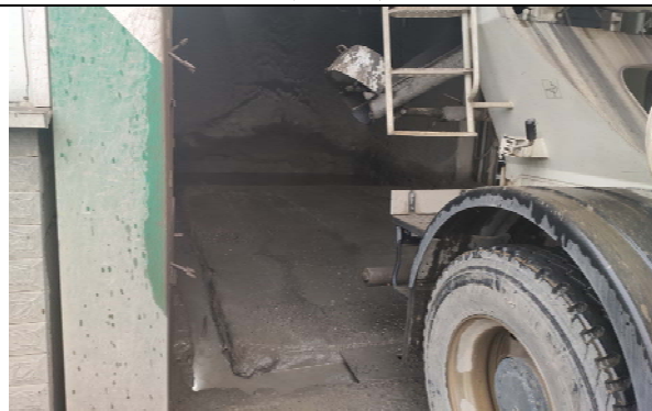
搅拌主楼洗车池
