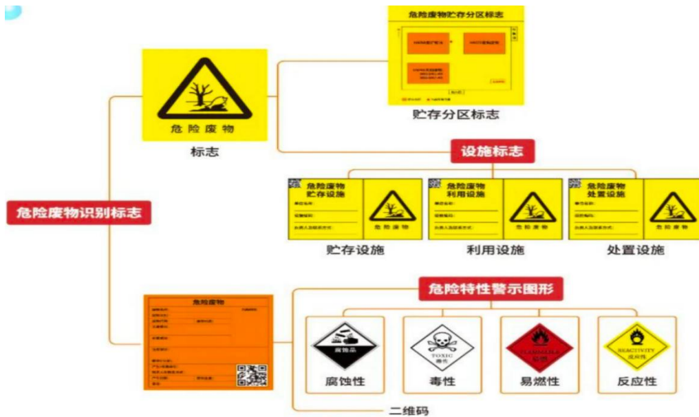
图 4-2 危废暂存间标识牌设置
