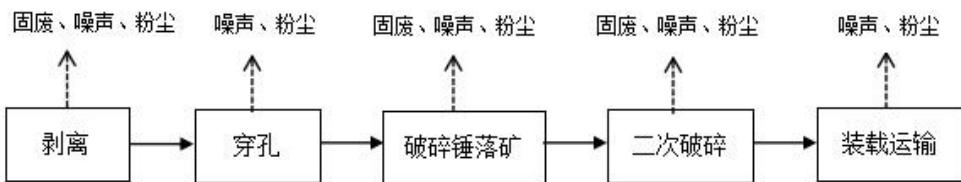
**图2-1 项目板岩和灰岩采矿工艺流程及产污节点图**
