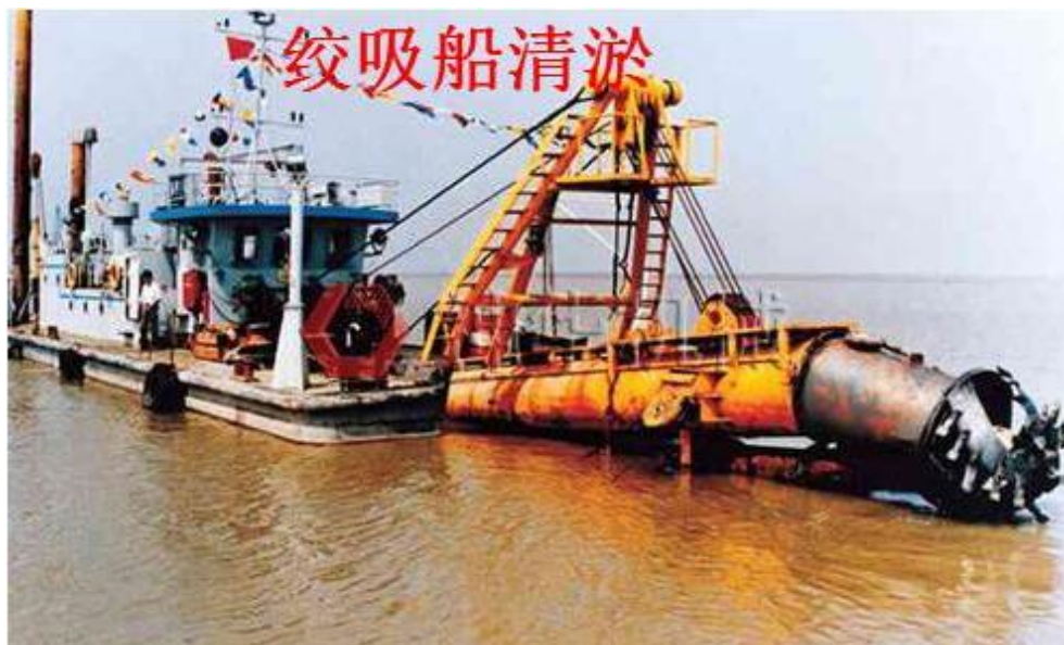
图 2.13-1 环保型绞吸船样图
