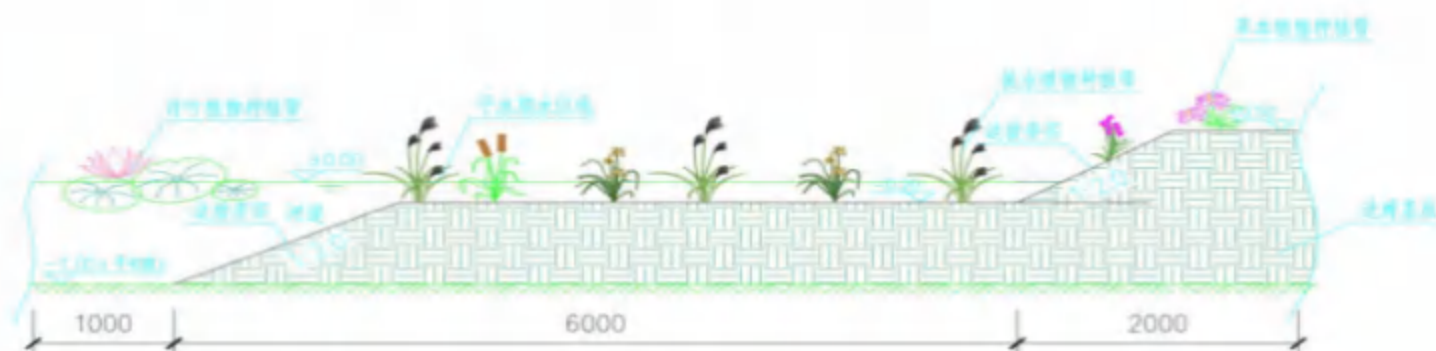
图 2-13 XFD-11 生态修复带做法
