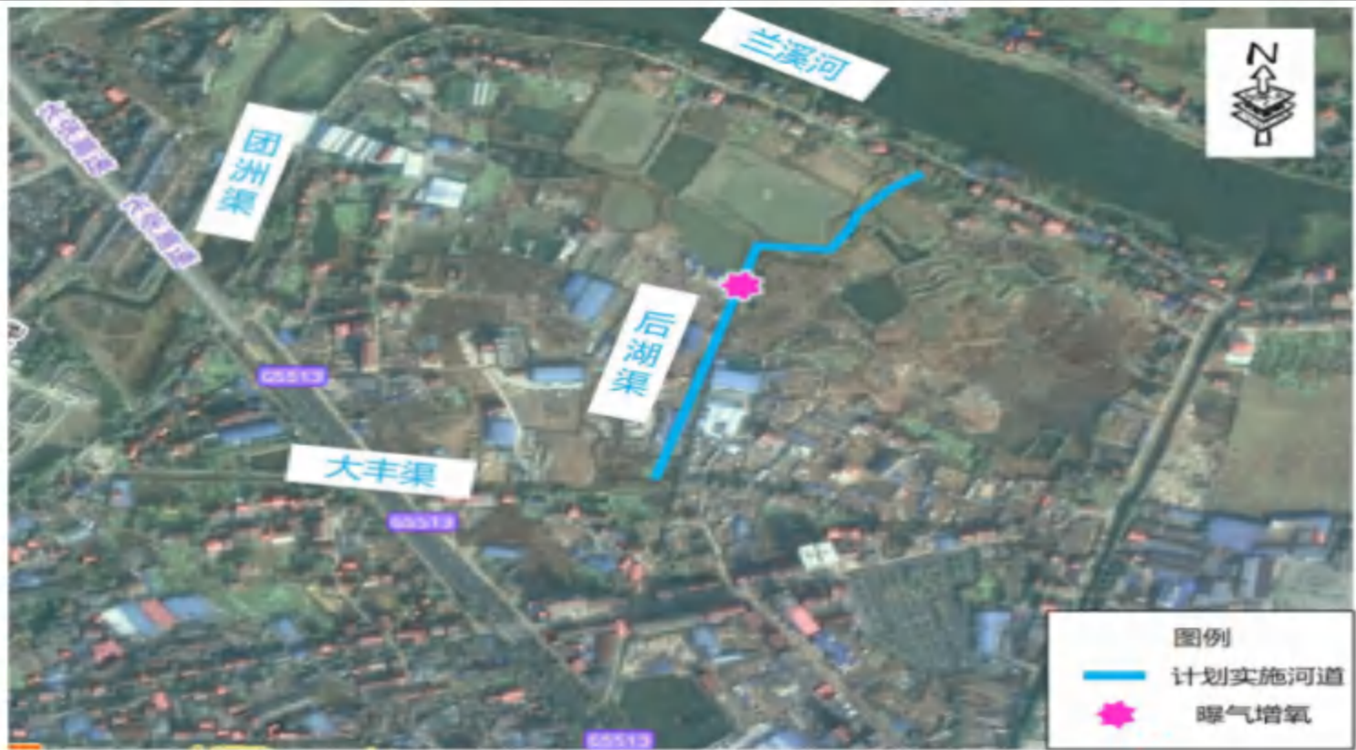
图2-18 后湖渠曝气增氧平面布置图
