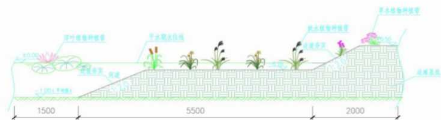
图 2-10 XFD-8 生态修复带做法
