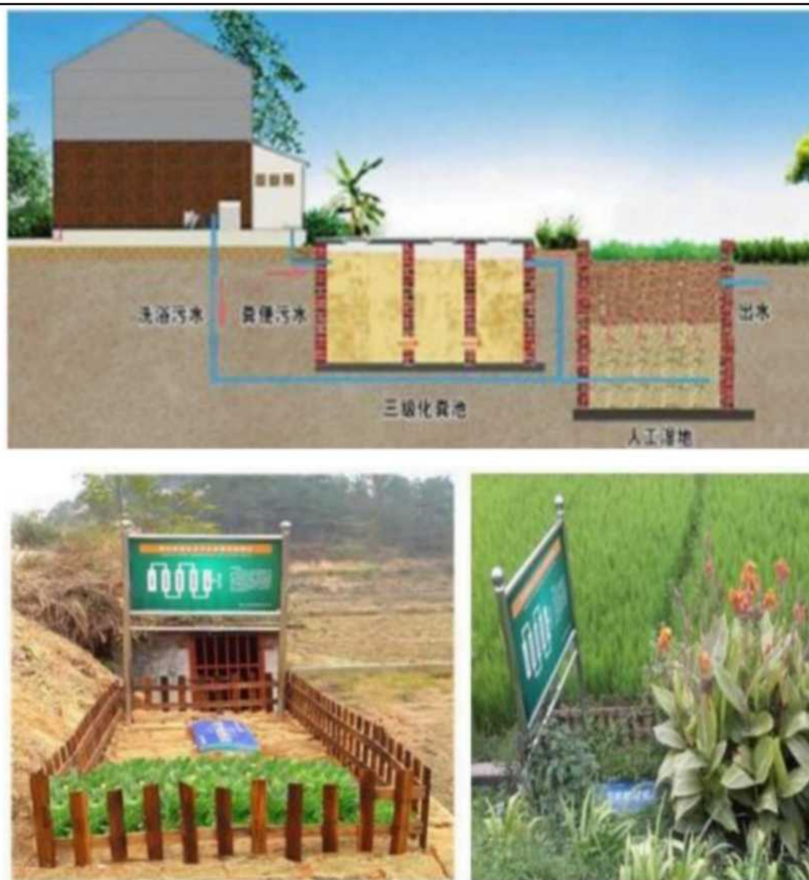
图2-23 四格污水净化系统示意图
