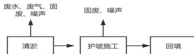
图 3.9-3 项目排涝渠整治工程施工流程及产污节点图
