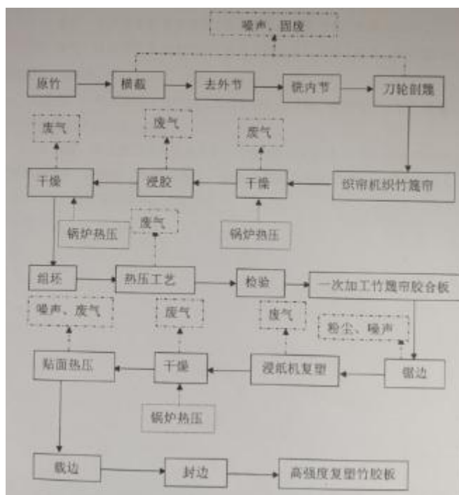
图 2-3 竹胶板生产工艺流程图
