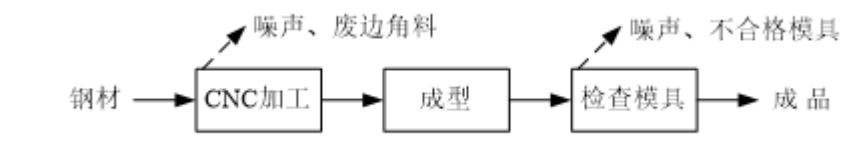
图 2-4 自用模具生产工艺及产污节点图
