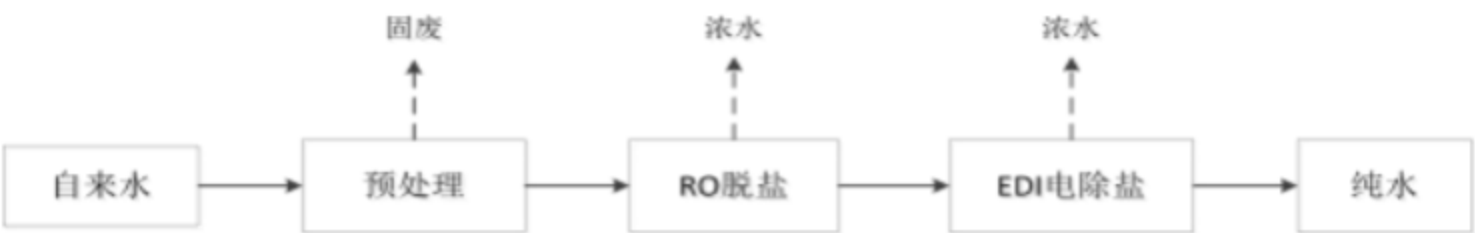
图 2-4 纯水生产工艺流程及产污环节图
