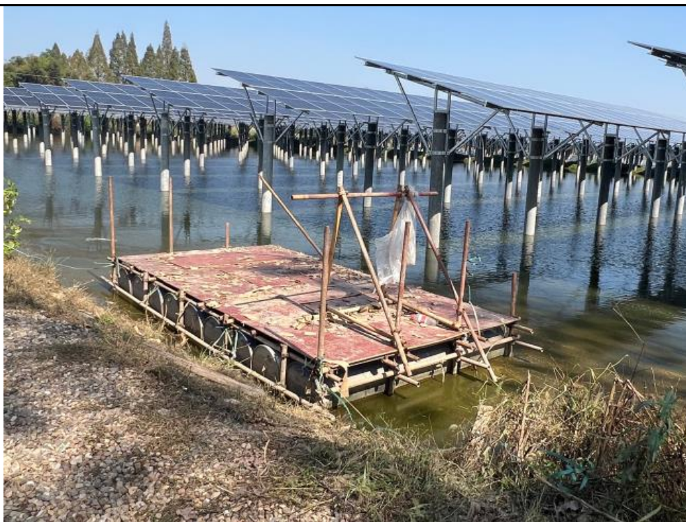
图 2.9-1 本项目施工期使用的船舶为废弃空油桶组建的浮筒船
