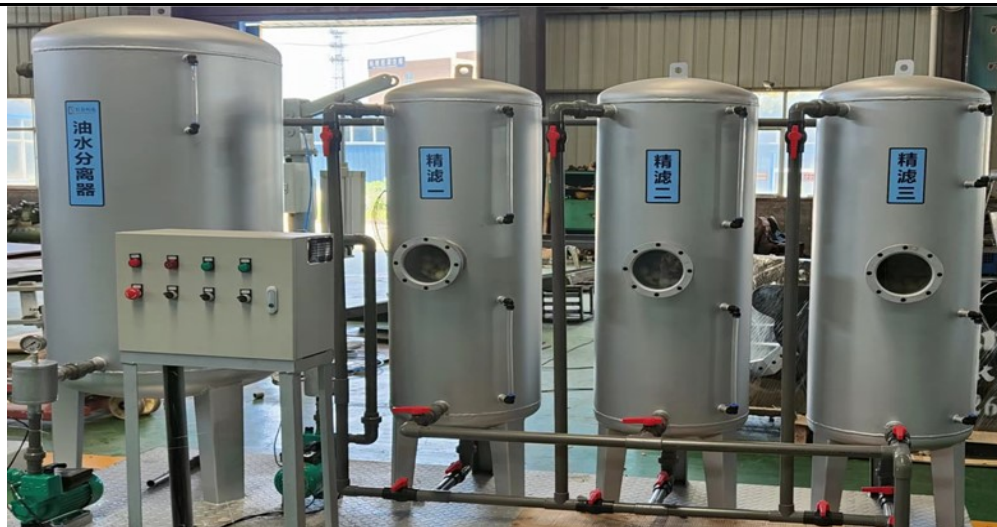
图 4-1 油水分离系统示意图
