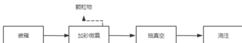
图 2-5 消失模铸造工艺流程及产污节点图
