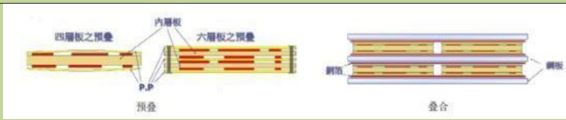
图 1.1.2-8 预叠和叠合结构示意图
