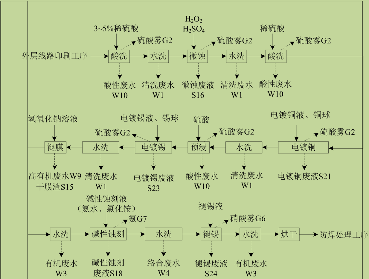
图 1.1.2-16：正片制作工艺及产污节点图
