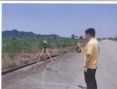
变电站厂界东侧外电磁场监测
