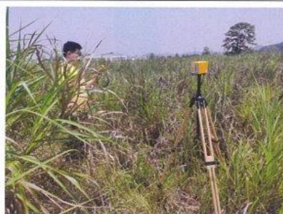
变电站厂界北侧外电磁场监测
