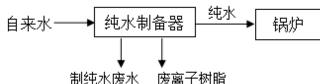
图 2-5 天然气锅炉运行流程及产污节点图
