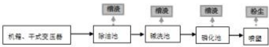
图 3.3-3 油浸式电力变压器工艺流程
