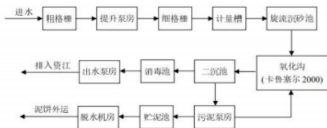
图 4.3-1 城北污水处理厂污水处理工艺流程图
