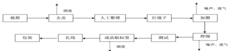
图 3-2 线束生产工艺流程及产污节点图
