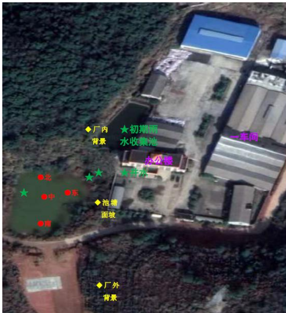
图 3-2 底泥与水质采样布点总图
