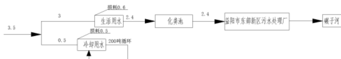
图 3.2-5 本项目水平衡图（单位：m³/d）
