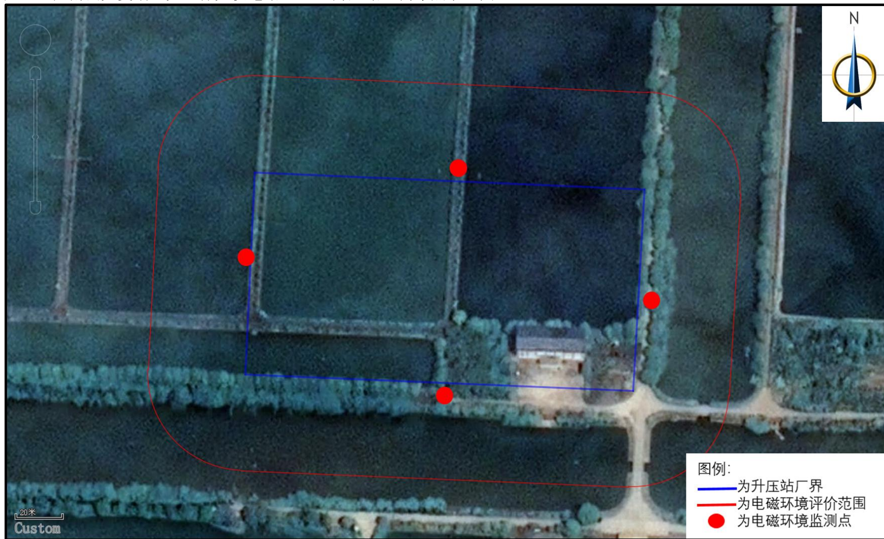
附图 3：益阳南县光复湖渔光一体光伏电站 220kV 升压站监测布点示意图
