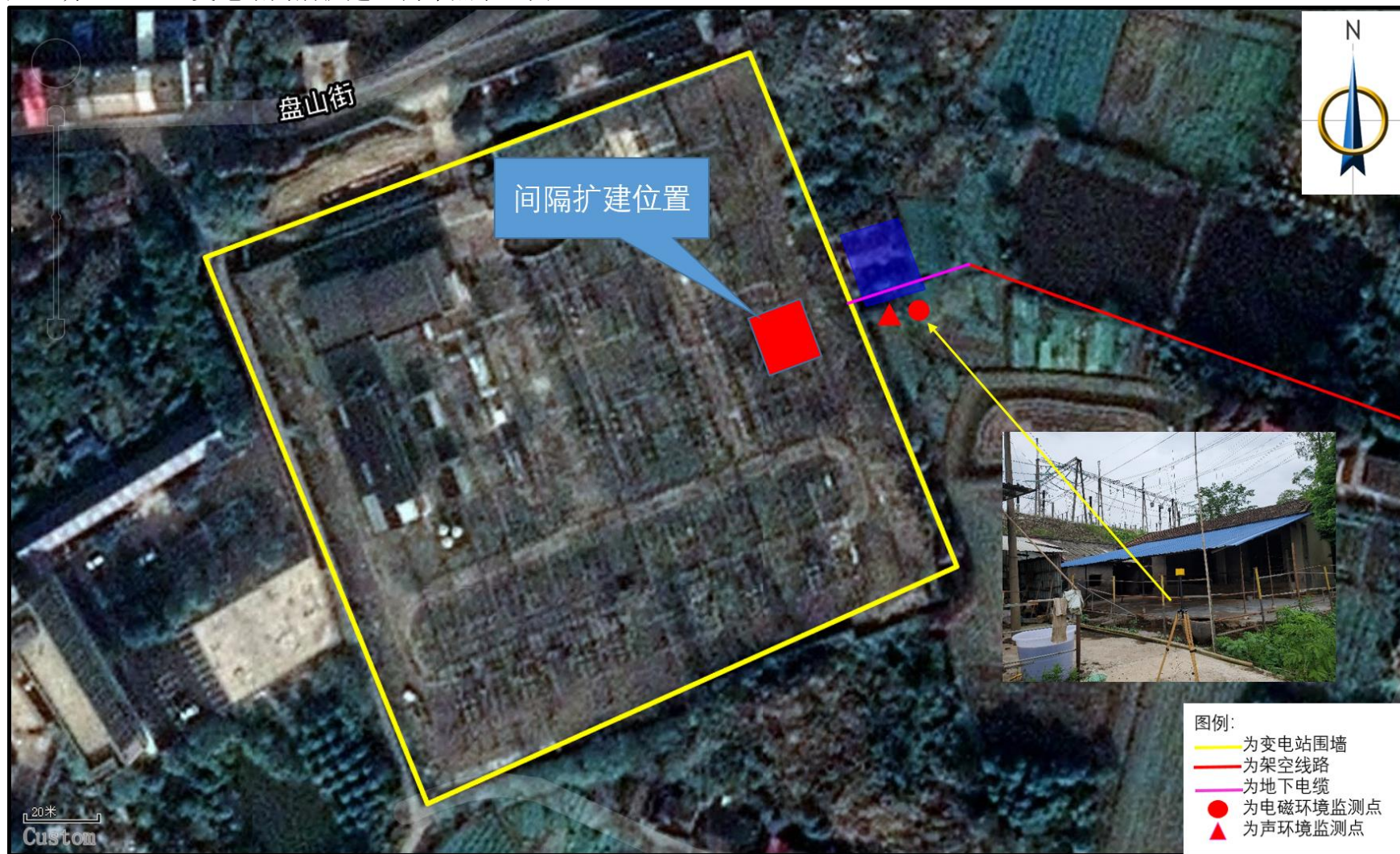
附图 5：明山 220kV 变电站间隔扩建监测布点示意图
