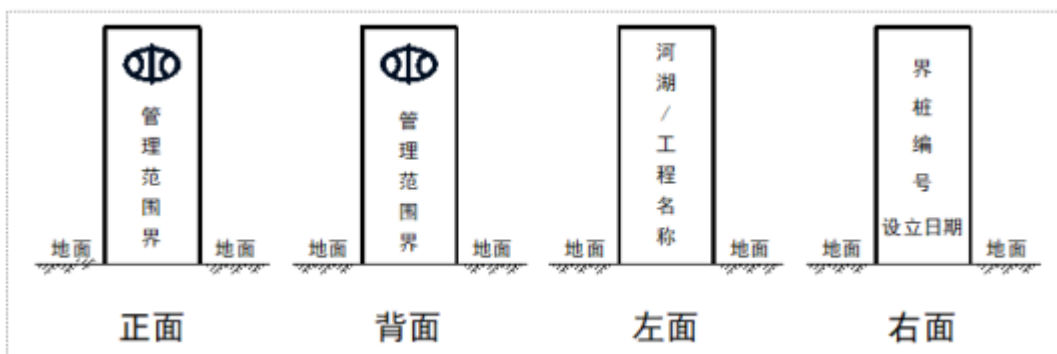
图 1-10 湖区界桩设计示意图
