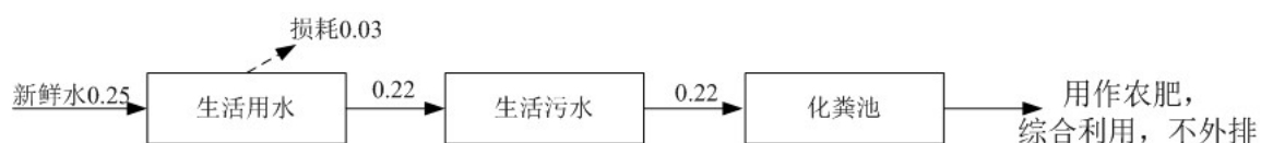
图 1-1 水平衡图（单位： \text{m}^3/\text{d} ）
