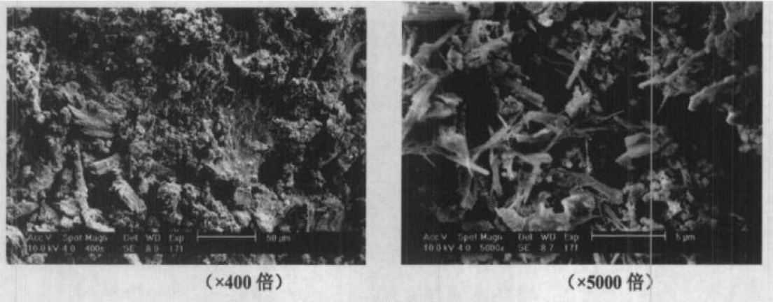
图 8.4-1 不同放大倍数下炉渣电镜扫描图
