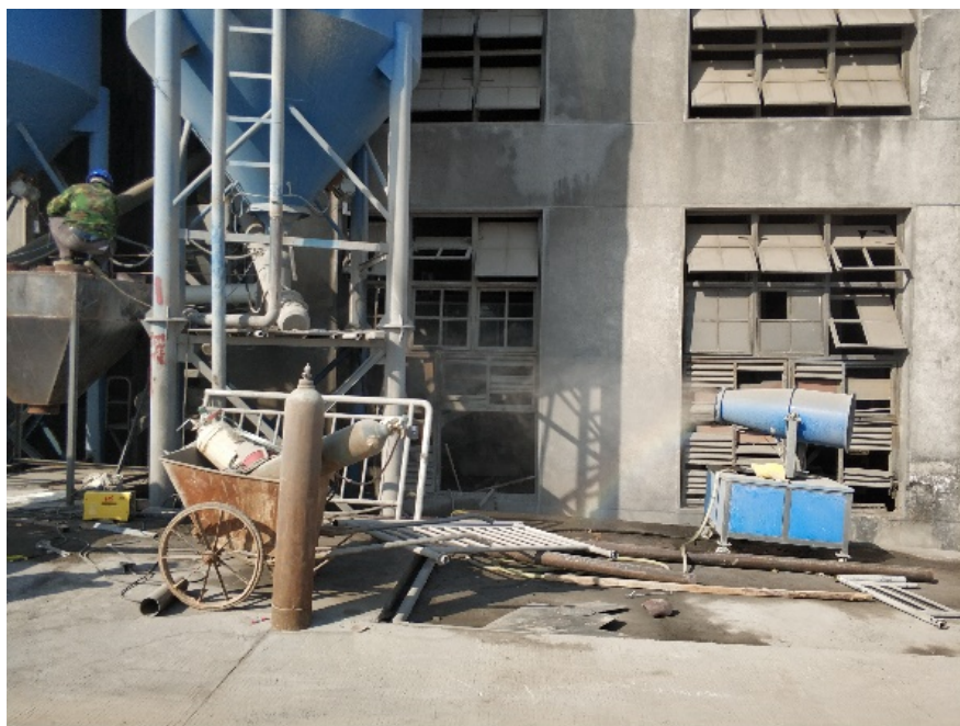
图 3.4-8 筒仓扬尘控制措施照片
