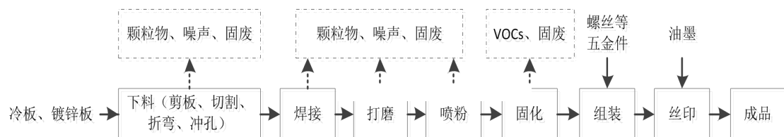
图 5-1 生产流程图及产污节点图
