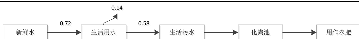
图 1-1 项目用水平衡图 m 3 /d
