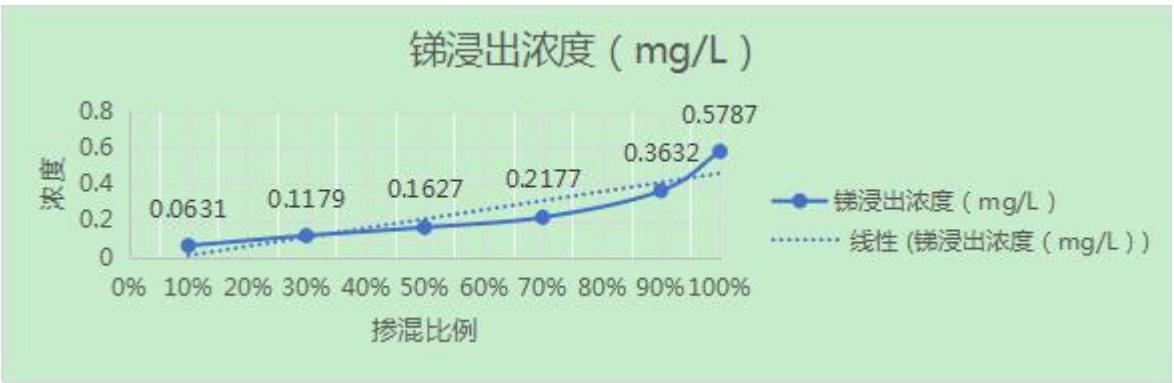
图 1-4 28d 水稳料样品掺混比例与锑浸出浓度曲线图
