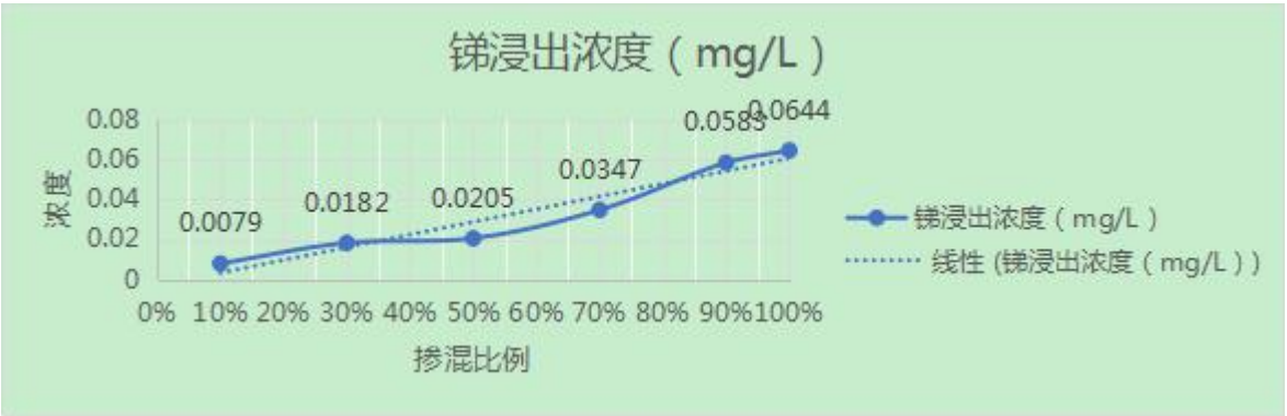
图 1-3 28d 水泥砖样品掺混比例与锑浸出浓度曲线图
