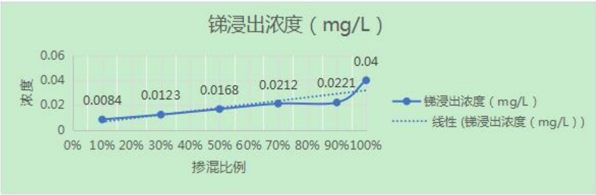
图 1-2 28d 混凝土样品掺混比例与锑浸出浓度曲线图
