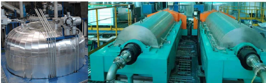
图 2.7-4 加热罐（蒸汽加热）三相分离机
