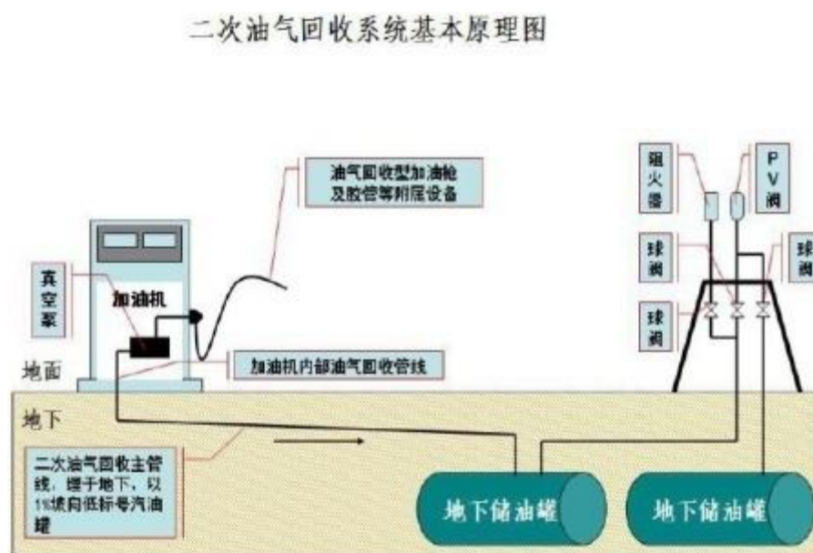
图 5-4 二次油气回收系统基本原理图
