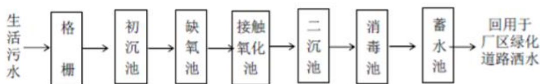
图 7.2-1 地埋式一体化处理装置工艺流程图
