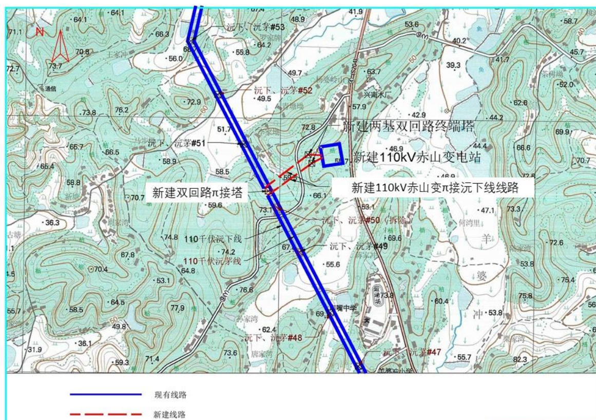
图 3 本工程线路路径示意图
