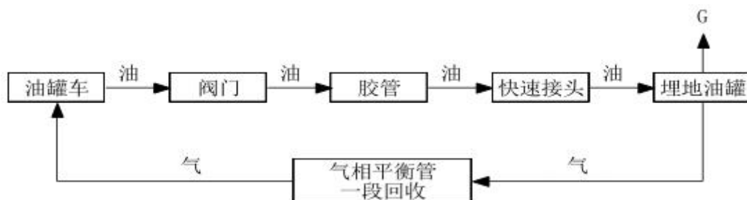
图 3.6-1 卸油工艺及污染流程图 (G 表示废气)
