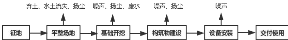
图 5-1 污水处理站厂区施工期工艺流程图
