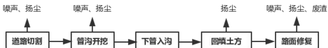
图5-2 管网铺设施工期工艺流程图
