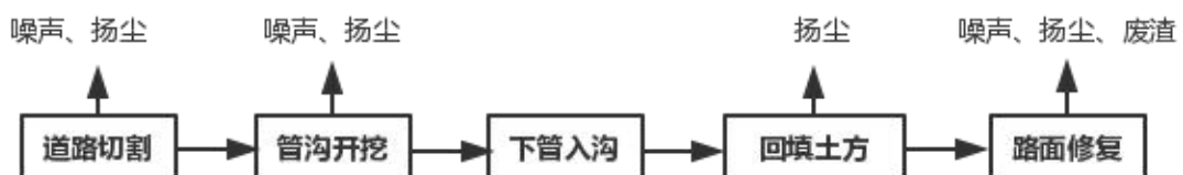
图5-2 管网铺设施工期工艺流程图
