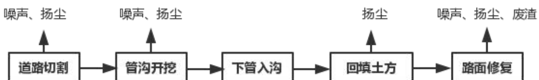
图5-2 管网铺设施工期工艺流程图
