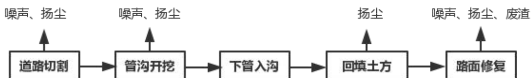
图5-2 管网铺设施工期工艺流程图
