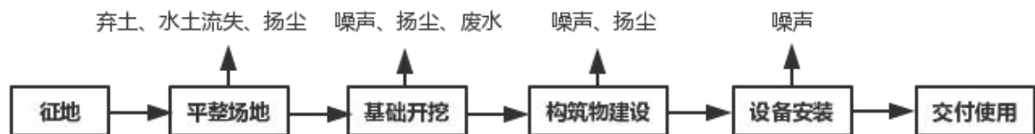
图 5-1 污水处理站厂区施工期工艺流程图
