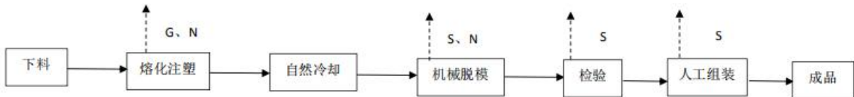
图 4-1 塑料模具生产工艺流程及产污节点图
