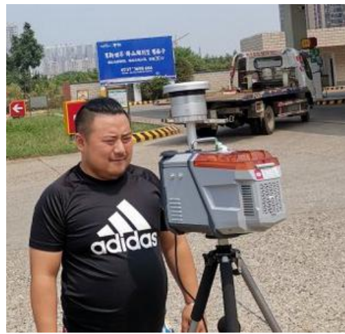
现场无组织废气监测 2
