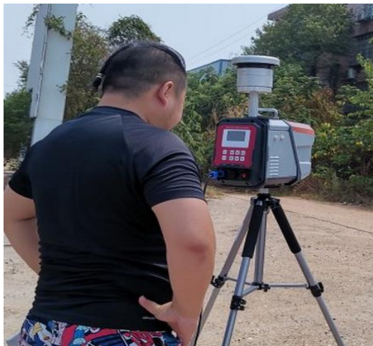
现场无组织废气监测 1
