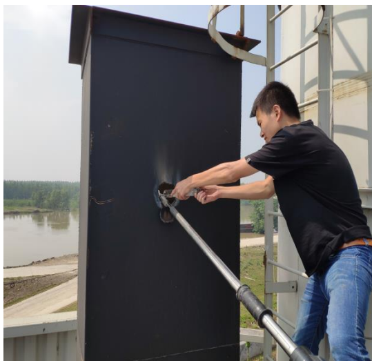
现场有组织废气监测 1
