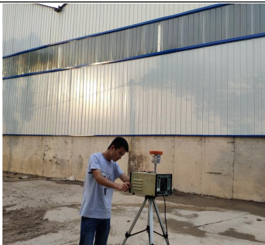
现场无组织废气监测 1
