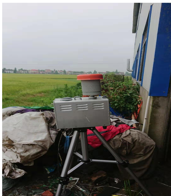
废气监测现场采样图
