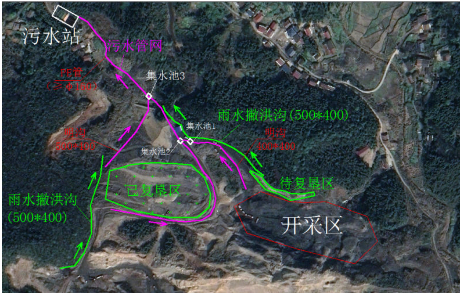
图 3-2 拔英湾污水管网图
