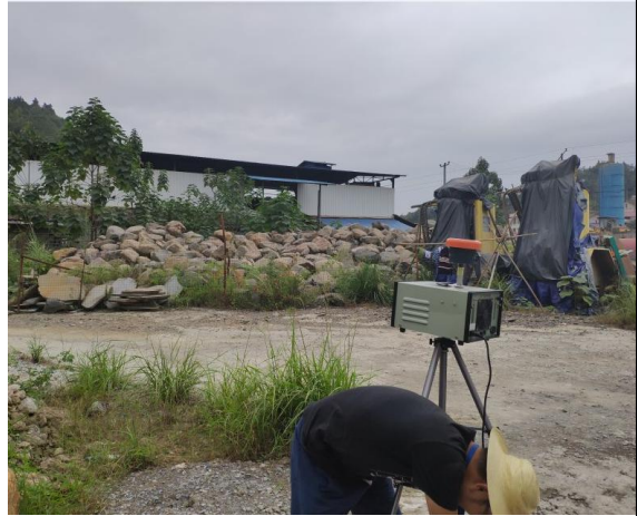
现场无组织废气监测 2
