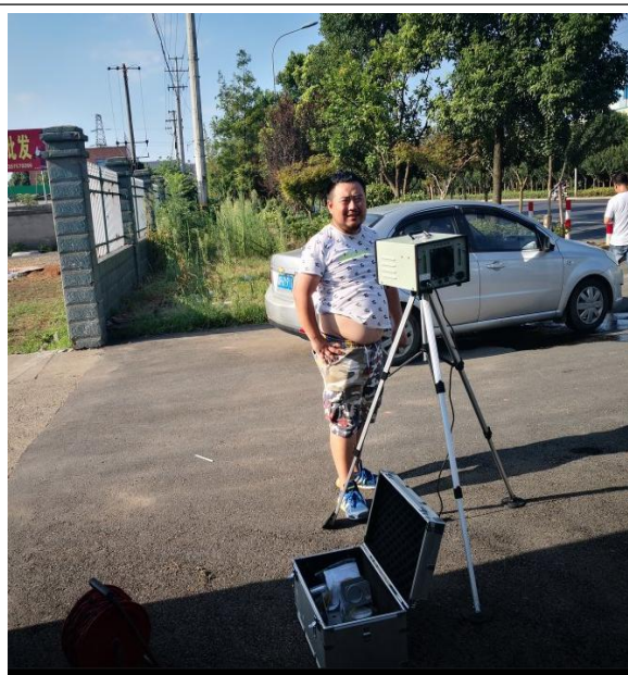
现场无组织废气监测
