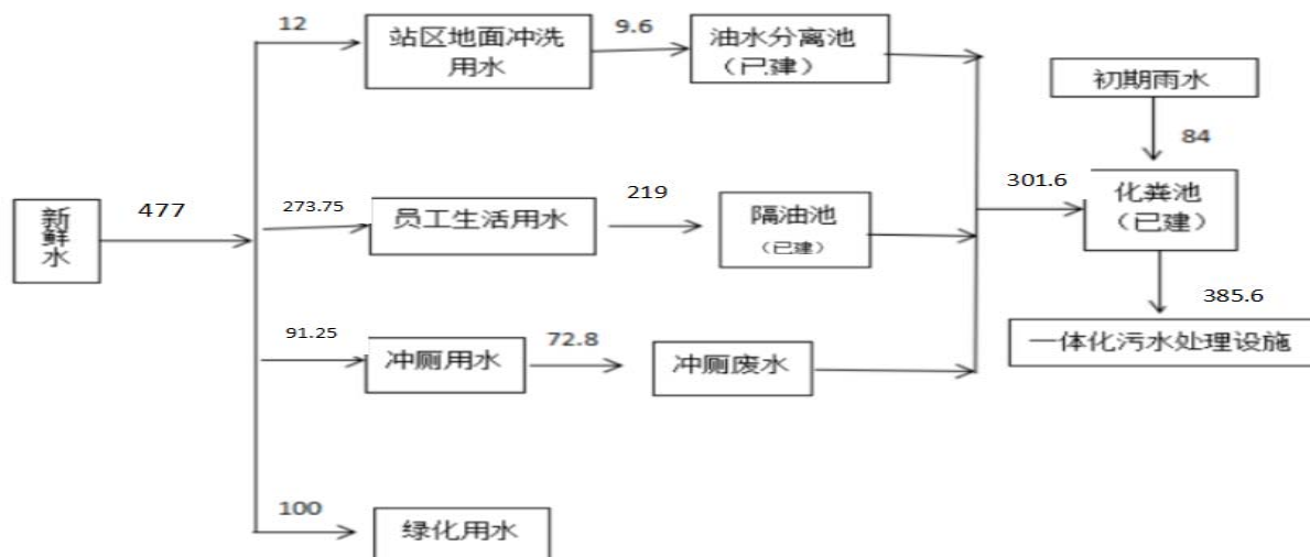
图 3-1 项目水平衡图 (t/a)
